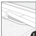
Retirez le revêtement de sol existant si nécessaire. Si la surface actuelle est adaptée, solide et relativement lisse, il est possible de sauter cette étape. En cas de retrait de tapis ou de vieux vinyle, vous pourriez avoir besoin d'un grattoir électrique et d'un solvant à base d'agrumes pour éliminer les anciens adhésifs, en veillant à ne pas oublier les coins et les crevasses.
