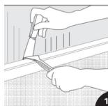
Retirez les seuils et autres moulures avant de mesurer la pièce afin de déterminer la quantité de revêtement de sol à acheter. La surface à couvrir correspond à la longueur multipliée par la largeur de la pièce, à laquelle il faut ajouter la superficie des renforcements et placards. Au total obtenu, ajoutez environ 10 % supplémentaires pour compenser les pertes de matériau dues aux découpes.
