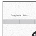
En partant de votre ligne de centre, alignez le premier panneau avec une précision maximale, car tous les panneaux suivants dépendront de ce premier alignement. Assurez-vous que tous les panneaux sont posés dans la même direction. À cet effet, des flèches sont imprimées sur l'envers des panneaux pour indiquer le sens de pose.
