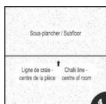
Installez les lames parallèlement à la principale ligne de vue, généralement le mur opposé à l'entrée. Repérez et marquez le centre de la pièce, puis ajustez de manière à ce que les lames soient réparties uniformément de chaque côté. Utilisez un cordeau à craie ou un marqueur fin pour tracer la ligne centrale. Recoupez la première et la dernière rangée si nécessaire afin d'obtenir une disposition équilibrée.
