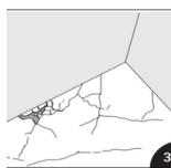
Utilisez un enduit de râgrage pour combler les fissures et les trous de votre sous-plancher. Appliquez le produit dans la cavité à l'aide d'un couteau à mastic, puis lissez la surface. Une fois que le plancher est régulier et uniforme, balayez et lavez soigneusement. Plus le sous-plancher est lisse, meilleure sera l'adhérence des lames de vinyle. Enfin, il est recommandé d'appliquer une couche d'apprêt pour sceller les sous-planchers très poreux ou les surfaces difficiles à coller.
