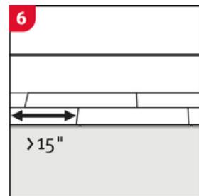
Décalage des joints d'extrémité. La distance minimale entre les joints d'extrémité des planches dans les rangées parallèles doit être d'au moins 15" pour des planches de 48" à 60" et de 22" pour des planches de plus de 72".
