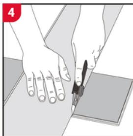
Couper les planches pour les ajuster. Pour couper la planche, utilisez un couteau utilitaire et une règle. Avec le dessus de la planche vers le haut, appuyez fortement tout en entaillant, en coupant profondément plusieurs fois le long de la même ligne. Le couteau n'a pas besoin de traverser la planche. Ensuite, en maintenant un côté avec une main, soulevez l'autre côté là où la planche a été coupée. La planche se séparera naturellement.
