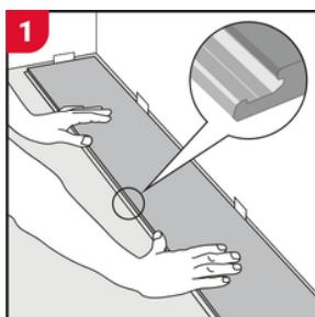
Première rangée, première planche. En commençant par le coin gauche, placez des cales de 3/8" contre les murs de chaque côté et placez la première planche avec le côté rainure orienté vers l'extérieur.
