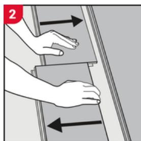
Démontez chaque planche en faisant glisser les extrémités courtes horizontalement. Ne soulevez jamais la planche vers le haut, car cela pourrait endommager le système d'emboîtement.
