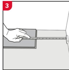
Fin de rangée. À la fin de la première rangée, placez une cale de 3/8" contre le mur et mesurez la longueur de la dernière planche pour l'ajuster. Coupez à la dimension et installez-la.
