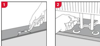
Percez des trous deux fois plus larges que le diamètre des tuyaux. Retirez un morceau de la planche à l'aide d'un couteau utilitaire. Placez la planche d'un côté des tuyaux et le morceau découpé de l'autre côté. Collez les bords découpés ensemble.
