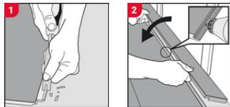
Retirez la partie verticale du système d'emboîtement de la lame à l'aide d'un ciseau. Appliquez de la colle sur la lame et poussez les planches ensemble pour les assembler. Assurez-vous que des cales de  $\frac{3}{8}$ " sont placées entre la dernière planche et le mur afin de maintenir l'espace d'expansion requis.
